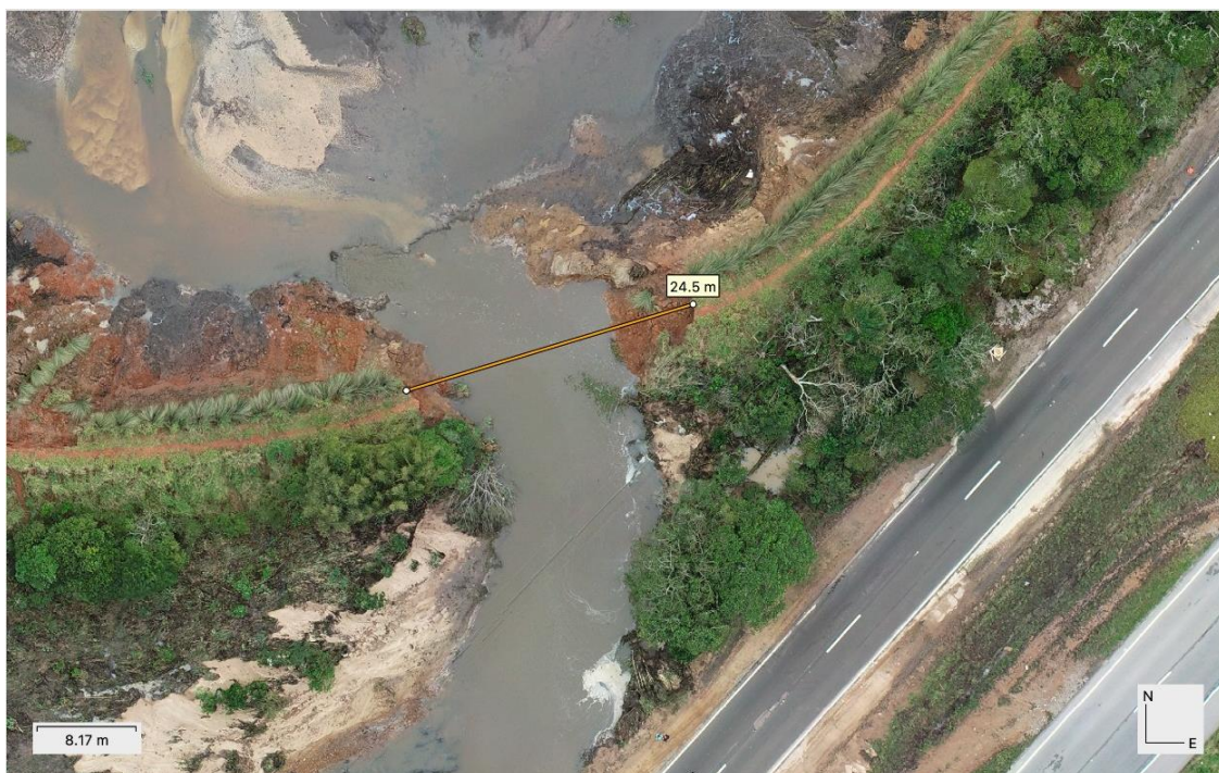
Figura 12: Ortomosaico produzido a partir das imagens de drone demonstrando em detalhe o rompimento da taipa (Código SNISB 30938).
