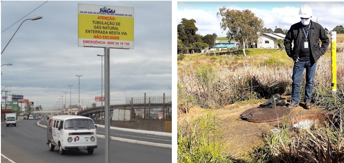
Figura 30 - Exemplos sinalização (placa de sinalização em via urbana, marco de sinalização em área rural)
