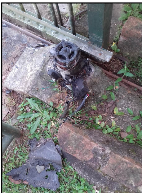
Imagem 01 e 02 – Motor do portão após ocorrência do princípio de incêndio
