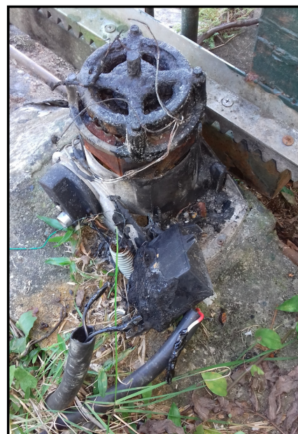
Imagem 01 e 02 – Motor do portão após ocorrência do princípio de incêndio
