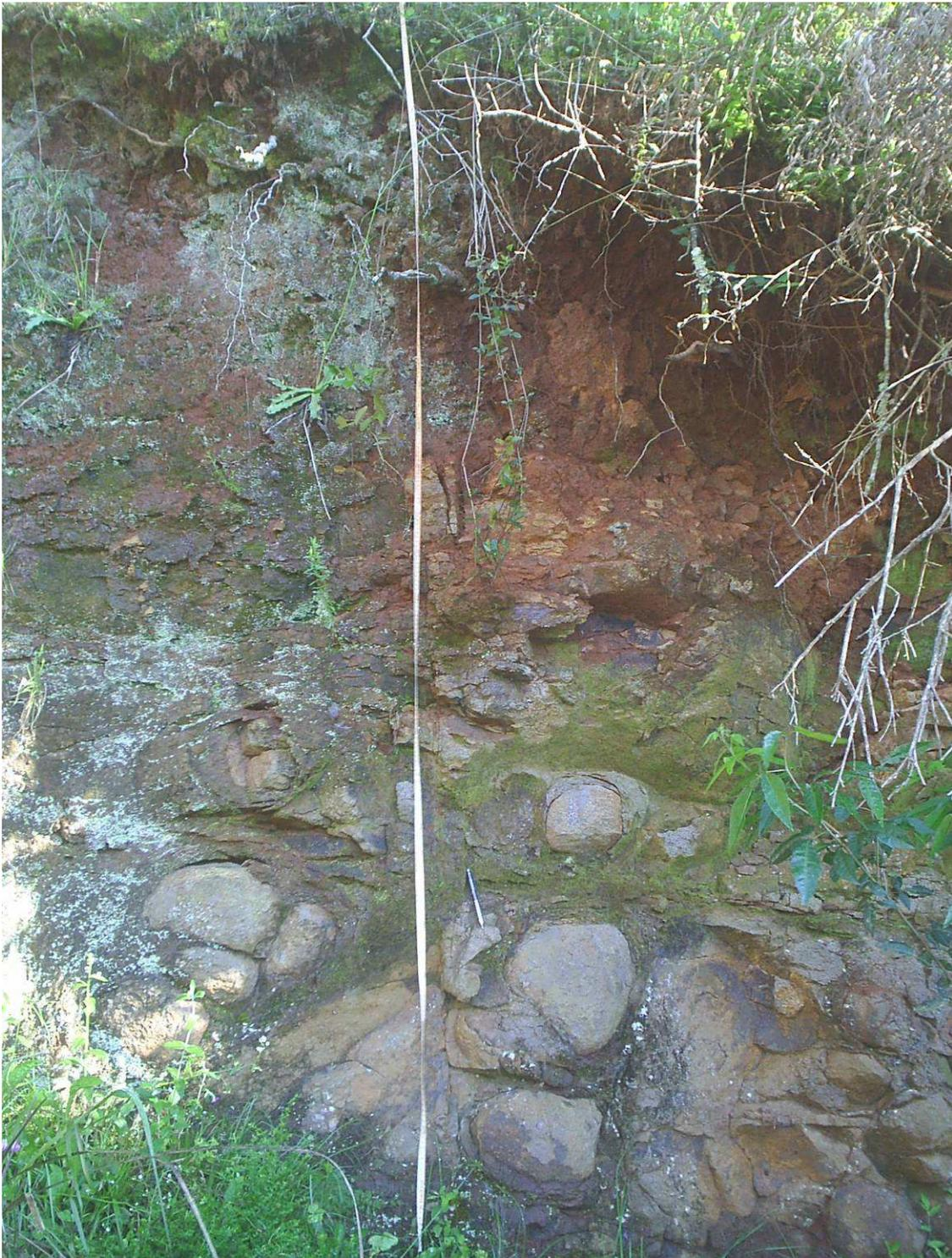
Imagem 1- Afloramento em paredão dentro da área da reserva de coordenadas UTM – SAD69 0253777 6943688, mostrando na porção superior uma fina camada de solo após temos a rocha alterada de coloração marrom acinzentada e na camada inferior a rocha mais sã de coloração mais acinzentada.
